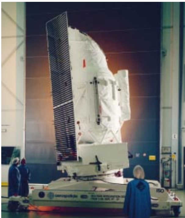
Abb. II. 14: Das 5.4 Meter hohe Infrared Space Observatory in der Montagehalle bei Aerospatiale. 2300 Liter superflüssiges Helium kühlten den gesamten Satelliten bis nahe an absoluten Nullpunkt ab. (Foto: DASA)
