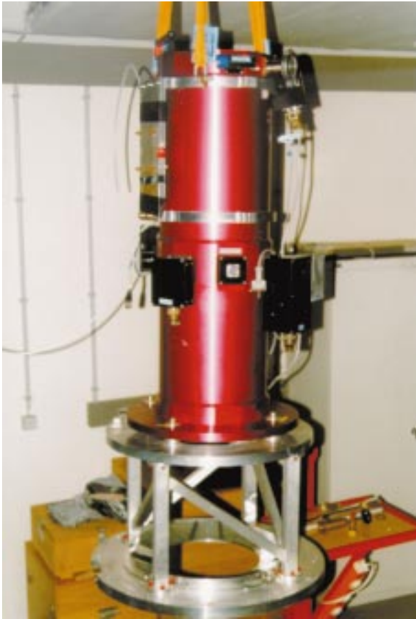
Abb.III.6: Die CCD-Einheit von OMEGA-Prime.
