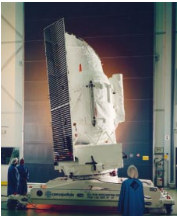
Abb.I.3: Der Satellit ISO war 5.4 Meter hoch und wog 2.4 Tonnen. Teleskop und Blendensystem wurden durch Heliumgas, das aus einem mit 2300 Litern superflüssigem Helium verdampfte, auf 1.8 Grad Kelvin gekühlt.
